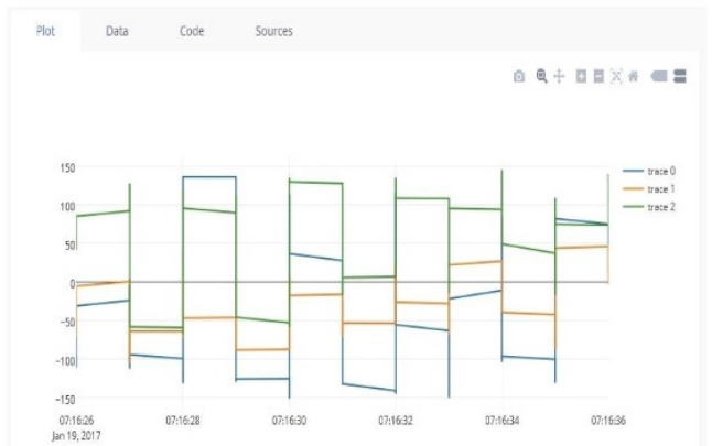
Gambar 14 Grafik Pengujian Sensor Accelerometer untuk nilai sumbu koordiat X, Y, dan Z.
