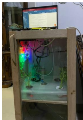
Gambar 5. Prototipe Smart showcase hidroponik khusus didalam ruangan.
